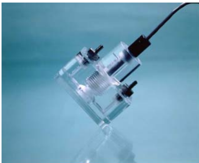
図 4.218 河川での水質事故を検出する毒物検知バイオセンサ
