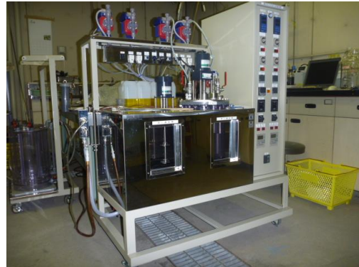
図-6.5 刈草の下水汚泥混合メタン発酵実験
