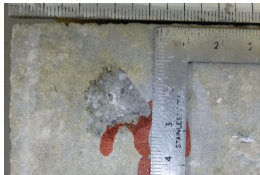
アルカリ量 2.2\text{kg/m}^3 の供試体のポッピングアウト
