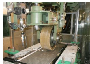
輪荷重試験状況
