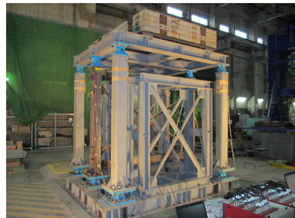
写真 3 振動台実験の全景
