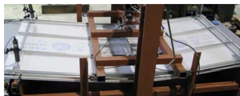
写真2 耐力の検討：曲げ実験
