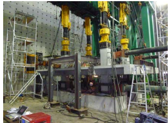
写真1 RC造部分架構実験
