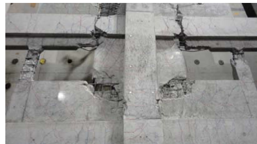
写真 2 壁付き架構実験
