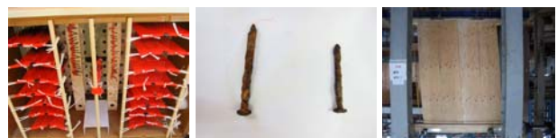
図3 塩水噴霧による釘の促進劣化と壁水平せん断試験の様子
