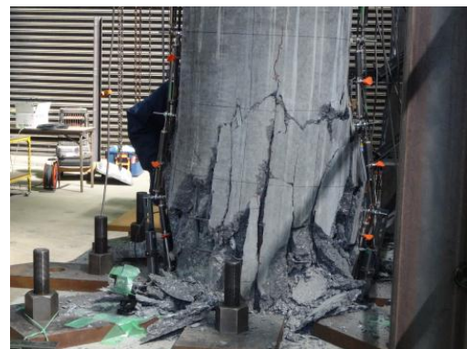
写真 4 実大 RC 既製杭の要素実験
