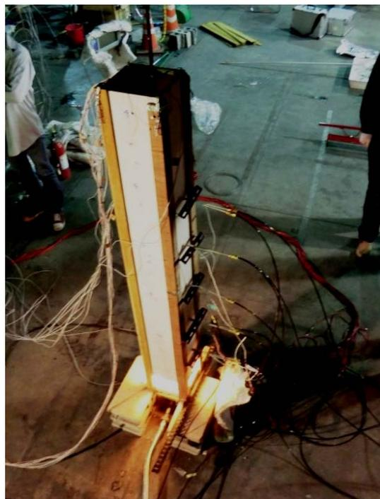
図4 煙突効果がシャフト空間の火炎性状に及ぼす影響に関する模型実験
