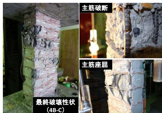
図 2 破壊状況
