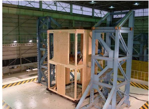
図4 振動台実験試験体
