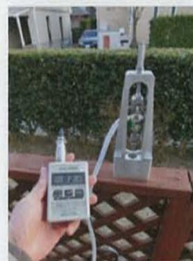
写真2 携行型引抜試験器
