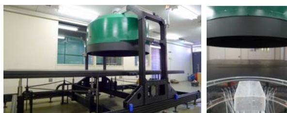
図2 竜巻発生装置の外観と模型の設置状況
