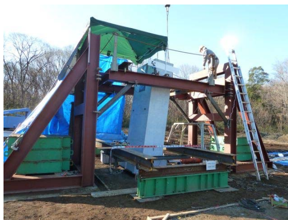
図2 ロッキング試験
