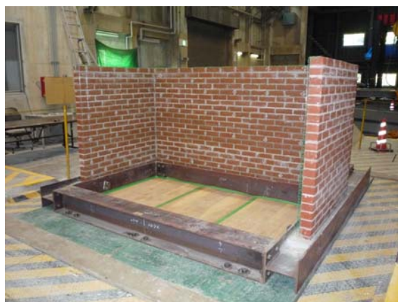
写真1 金網により補強された組積造試験体。
