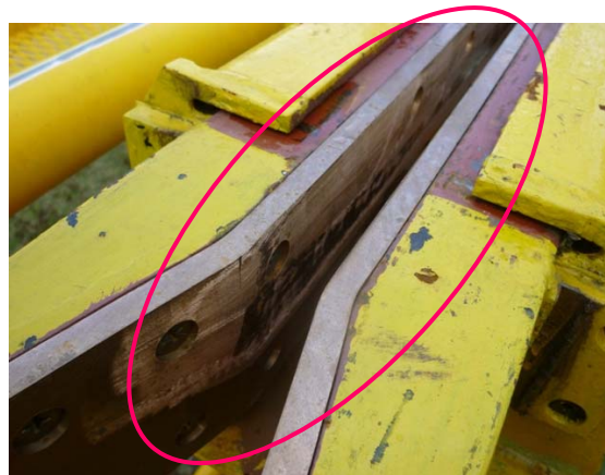
写真 1 4 ブレーキのライニングに摩耗粉が付着
