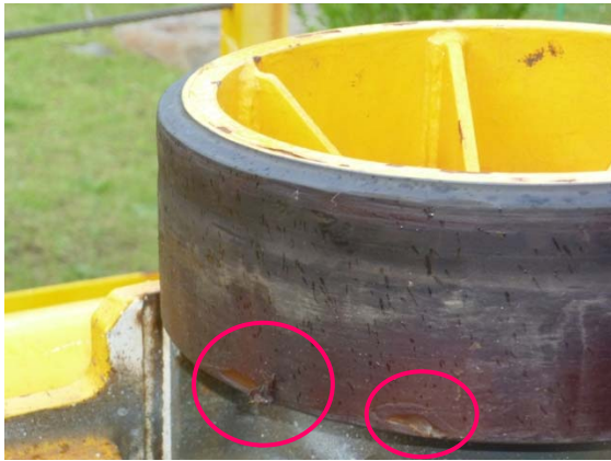
写真 1 2 送り出し装置のローラーの損傷
