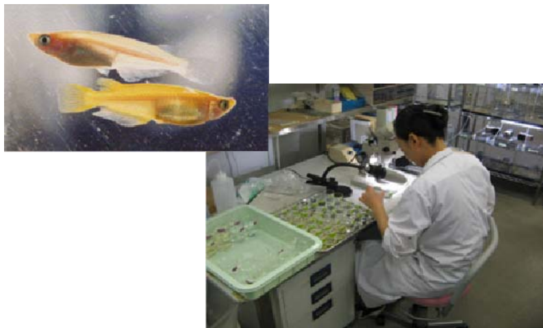
図 4.225 メダカ受精卵による生物応答試験 (WET)
