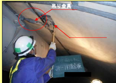
【ハンマーによる打音検査②】
