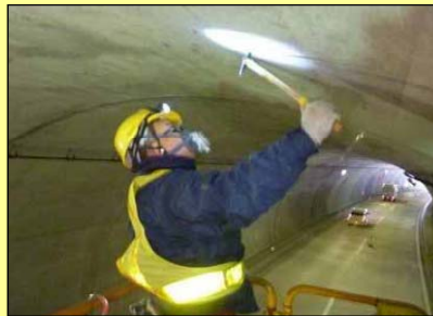
【ハンマーによる打音検査②】
