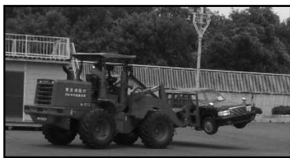
<放置車両移動のための具体的方策> (例:ホイールローダによる車両移動検討)
