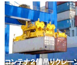
コンテナ2個吊りクレーン
