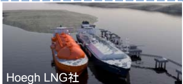
■右が洋上LNG受入施設、左がLNG運搬船
