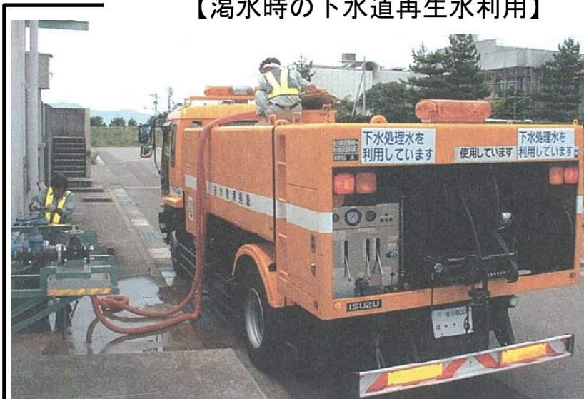
浄化センターから散水車への給水状況
