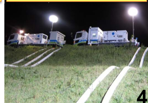
排水ポンプ車による緊急排水 (H25.9 台風18号 京都府福知山市)
