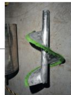
■ 洗浄ブラシ 流入した異物を下部へ落下させます
