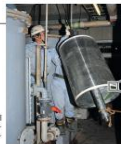
■ 回転円筒 多孔板からなるスクリーン 円筒の中に洗浄ブラシが入ります
