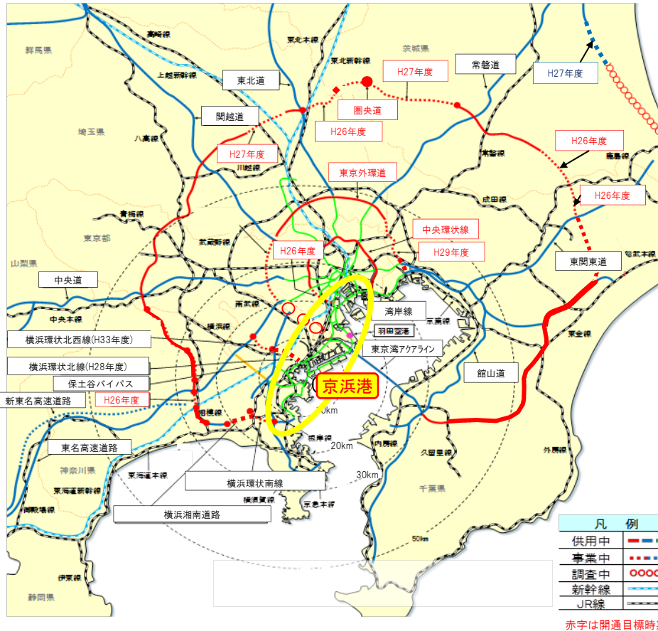
【整備が進む京浜港背後圏の広域道路ネットワーク】
