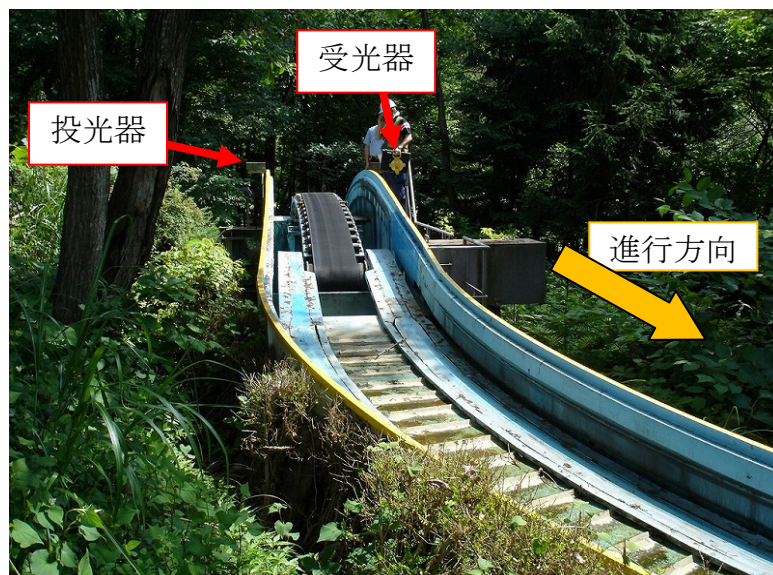
写真 I-1. 第2コンベア頂部到達検出センサー①
