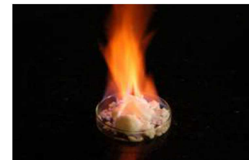
燃焼するメタンハイドレート(人工メタンハイドレート)
