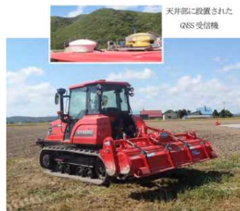
GNSS受信機を搭載したトラクタ
