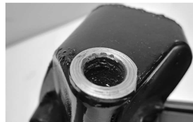
バンジョーボルト穴のネジ部分の腐食
