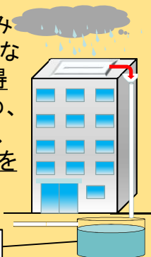
雨水貯留施設
