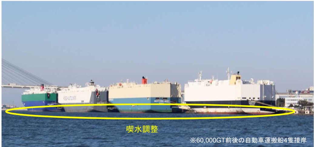
《岸壁水深不足による名古屋港の問題点》
