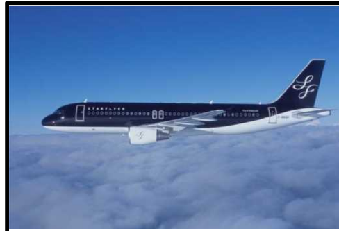
エアバスA320 座席数180席 全幅34.1m 全長37.6m 航続距離6,370km
