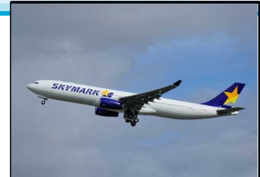
エアバスA330-300 座席数295席 全幅58.6m 全長62.6m 航続距離9,250km
