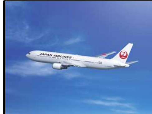
ボーイング767-300ER 座席数237席 全幅47.6m 全長54.9m 航続距離9,400km
