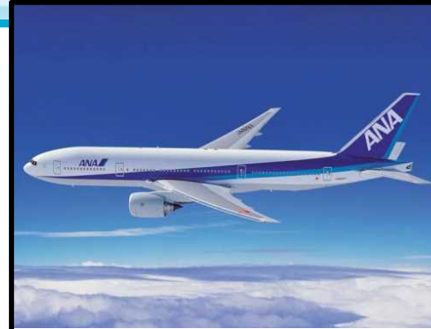
ボーイング777-200 座席数380席 全幅60.9m 全長63.7m 航続距離4,190km
