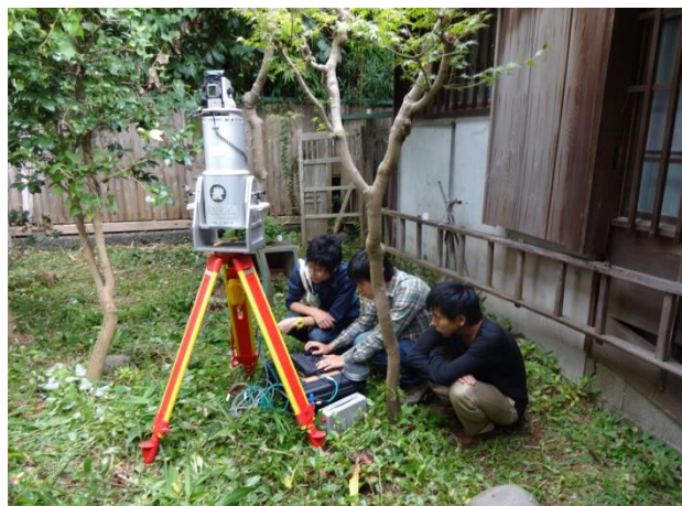
写真3-4 岡田邸における庭園調査の実施状況(3次元スキャナによる撮影)
