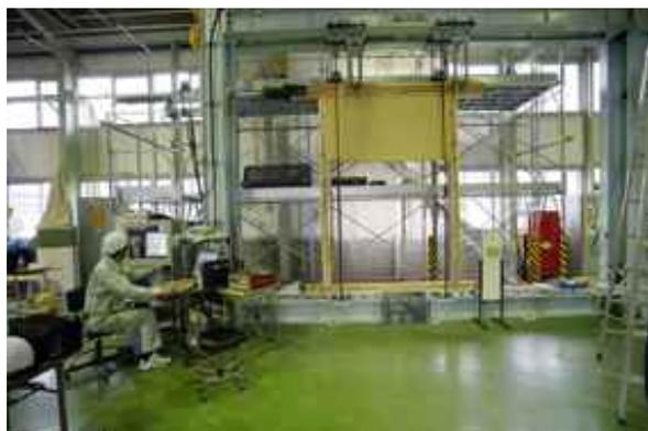
写真2-9. 垂れ壁の実大試験
