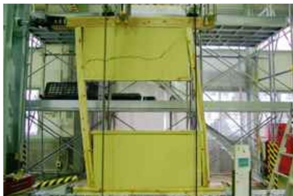
写真2-10. 垂れ壁と腰壁の実大試験
