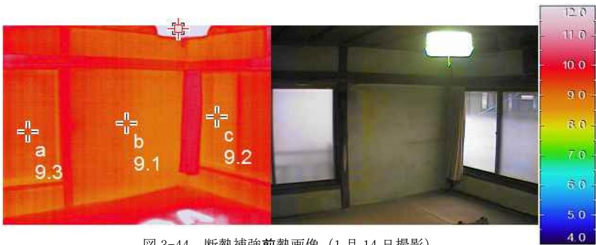
図 3-44 断熱補強前熱画像 (1月14日撮影)
