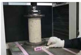
写真2-8. 一軸圧縮試験
