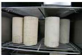
写真2-7. 試験体養生
