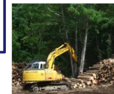
ハーベスタによる伐採作業
