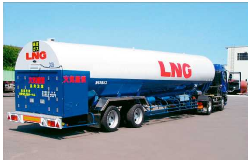
陸上輸送時(LNGローリー)
