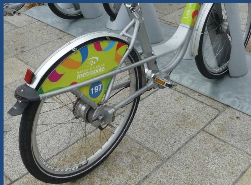
シャフトドライブ形式を採用するSaint-Étienneの車両
