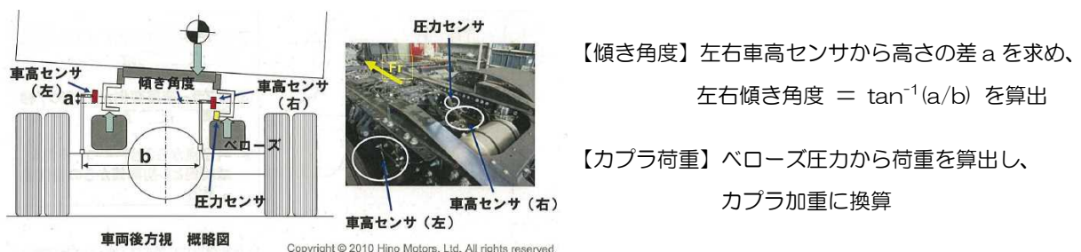
図36 左右傾きの検出原理
