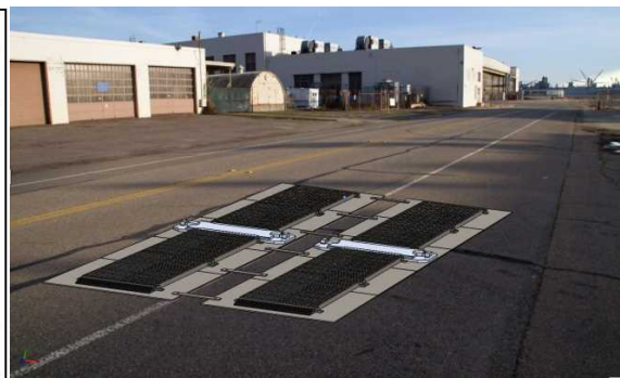
図45 路面設置型測定器の運用イメージ
