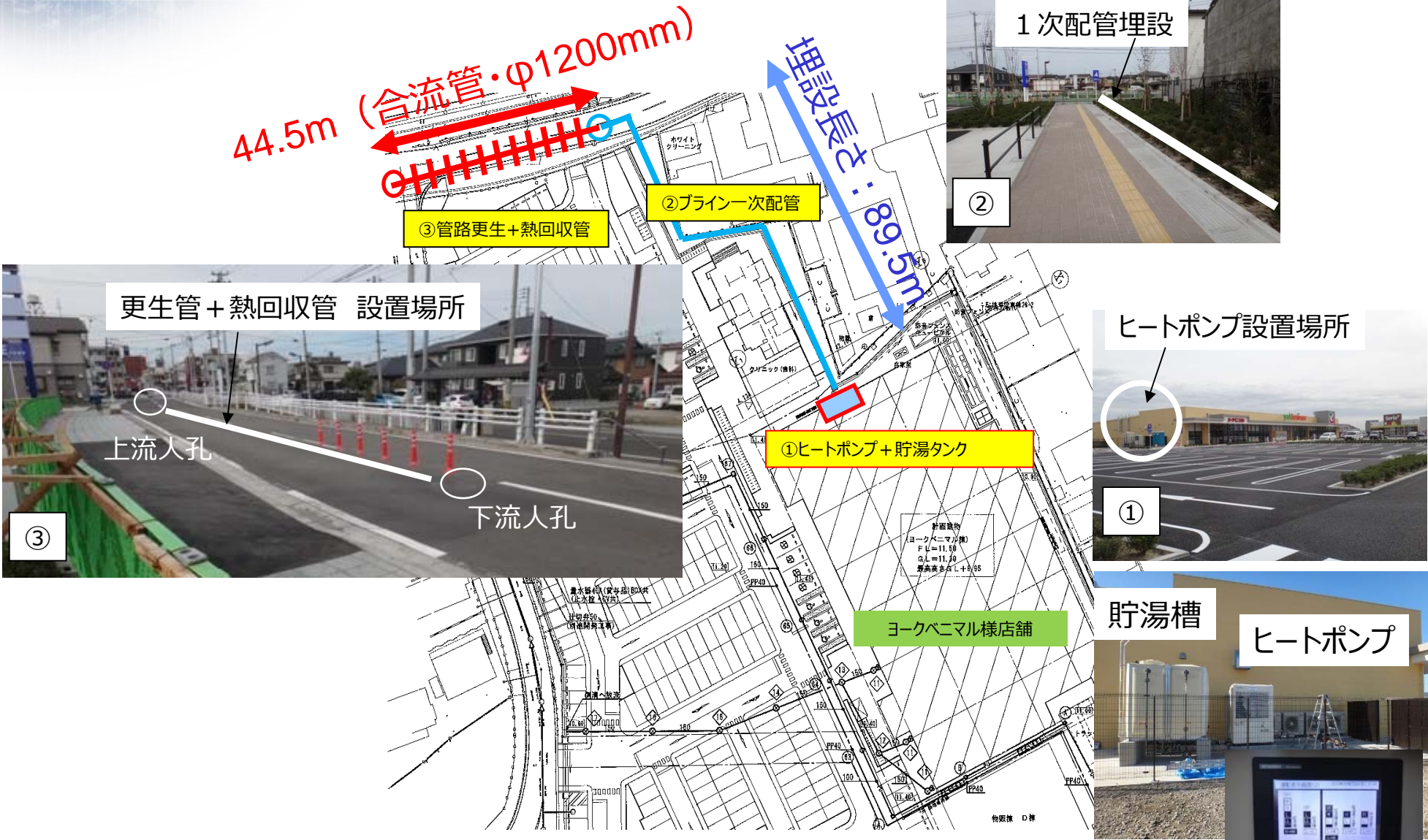
下水熱利用システムの設置場所
