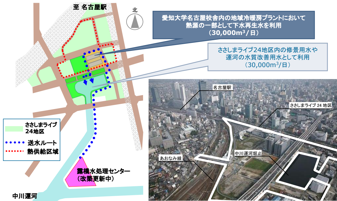
図 4-6 「ささしまライブ 24 地区」における下水熱利用の対象地域
