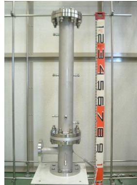
右 脱水素装置 (有機Hから水素を取り出す)
