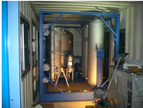
左 水添装置 (水素を有機Hへ変換)
