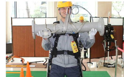
↑パワーアシストスーツ(イメージ) (韓国大宇造船で研究開発中のスーツ)
