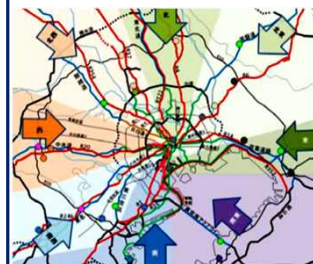
首都直下地震への備え 八方向作戦による道路啓開計画
