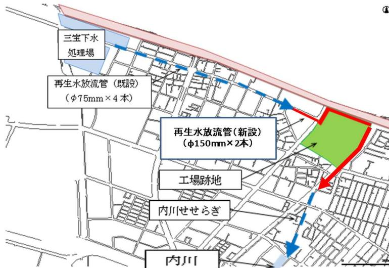
図 4-8 「堺市の大型商業施設」における下水熱利用の対象施設
