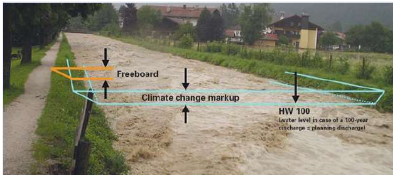
図 100年確率洪水位及び気候変動による水位上昇見込み量概念図
