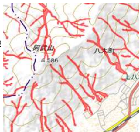
空中写真判読により電子地図に土砂流出箇所(赤)を重ね合わせた図を作成し、防災関係機関に速報
