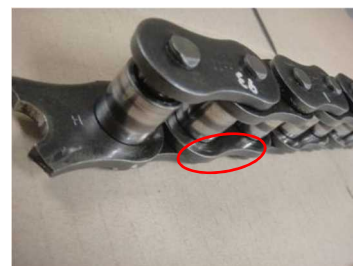
写真Ⅱ－10 内リンクプレート
