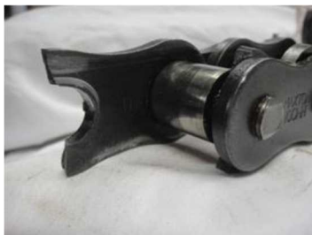
写真Ⅱ－9 外側破断部
