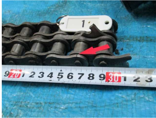
写真 I - 2 駆動くさり下部側の破断状況
