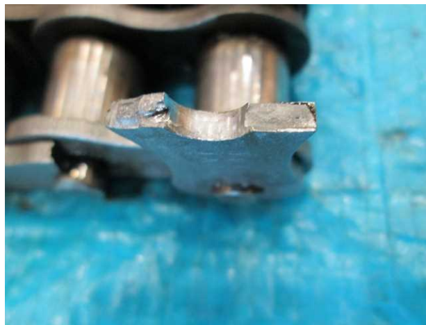
写真 I - 3 駆動くさり上部側の破断部
