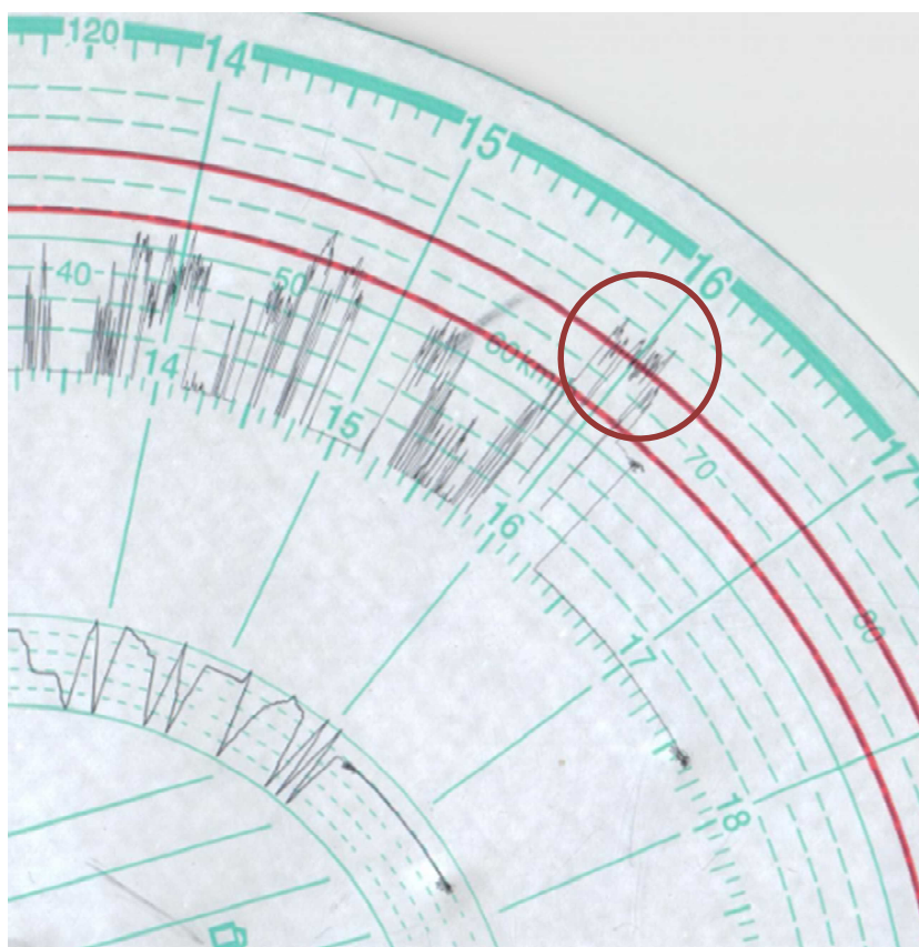
図2 事故当日の運行記録計の記録 (○部分が事故時)
