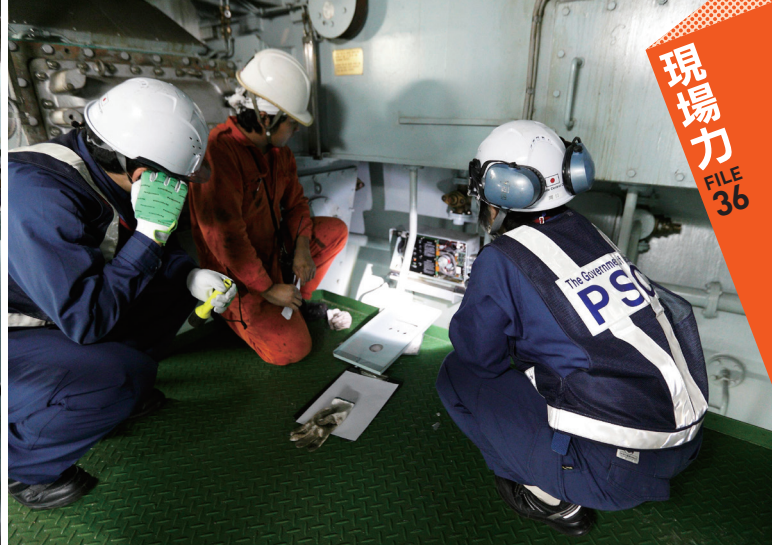
機関室でエンジンに問題があった際に作動するオイルミストディテクターの警報を実際に鳴らして確かめる。試験作動は船員に行わせ、動作に異常がないかだけでなく、船員に必要な知識や技術があるかどうかも確認する。
