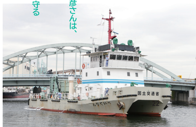
横浜の基地港から出発したべいくりん。全長は32.5m、総トン数199t。船体が2つ並んだような「双胴型」のデザインで、胴体間を抜ける海水からゴミや油を効率的に回収できる。
