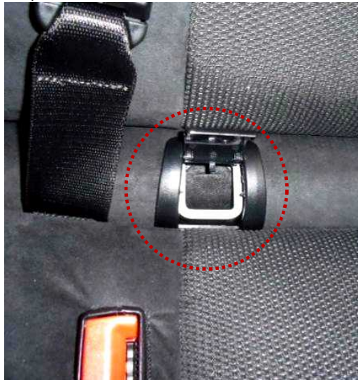
基準不適合発生箇所 ISOFIX チャイルドシート 固定ブラケット
