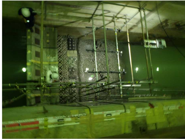
図Ⅲ-4.6 流速の時系列と実験後の被覆工の様子（上図において、赤線がV7における水平流速）
