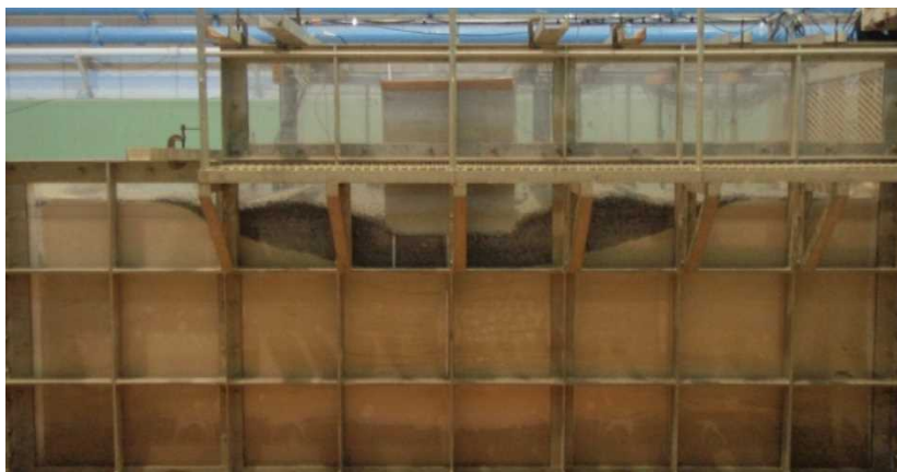
図Ⅲ-3.21 Case2の残留変形（加振を4回行った後に排水した状況）
