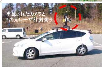
MMS(車両搭載型計測器)
