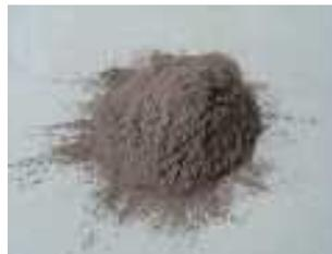
石炭火力発電所で微粉炭を燃焼した際に発生する石炭灰のうち、集塵器で採取された灰のこと。採取された灰は分級工程を経て細粉・粗粉に分けられ、品質試験を行いサイロで貯蔵、管理された後出荷される。コンクリートの混和材やフライアッシュセメントの原料として使用される。
