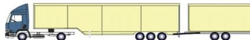
タイプ3: 全長25.25mまでの、台車軸および被牽引車を伴う貨物車
