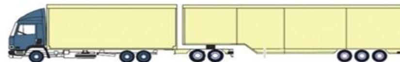
タイプ4: 全長25.25mまでの、台車軸および被牽引車を伴うセミ・トレーラー
