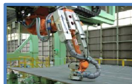
3次元CADと連動した加工自動化
