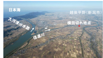
信濃川では、横田切れ、曾川切れなどの堤防決壊による大規模な河川氾濫が頻発していた。大正11年、大河津分水路の通水により、信濃川下流域の治水安全度は向上した。
