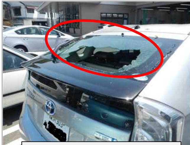
落石による車後部の破損
