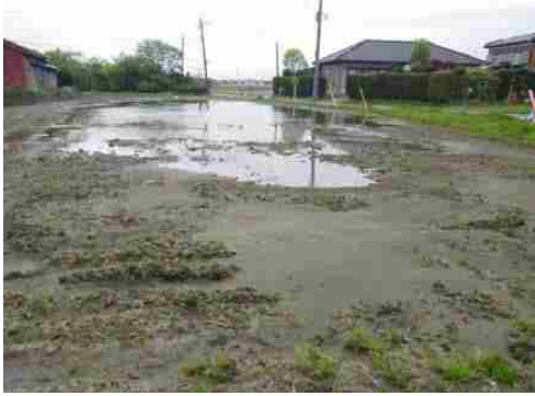
写真3-2 宅地地盤の液状化に伴う大規模な噴砂状況 6)
